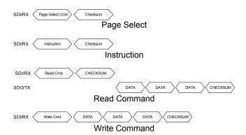
Figure 24. Byte Sequence for Checksum
