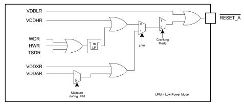
Figure 41. Analog die reset implementation
