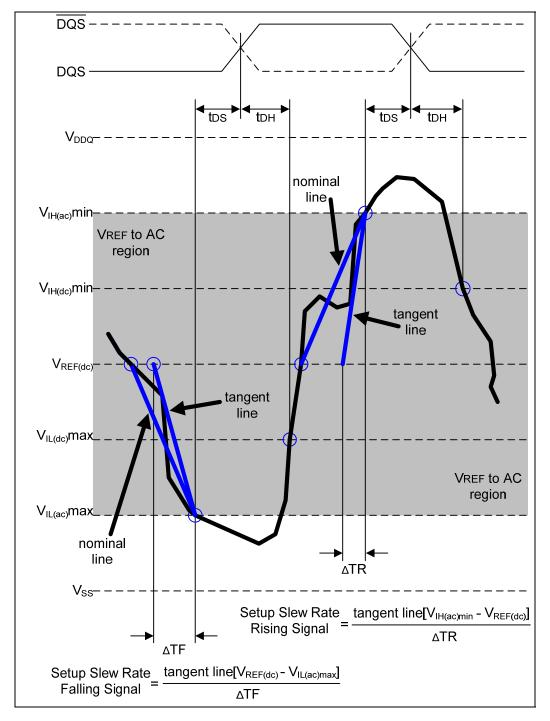
Figure 25 —Illustration of tangent line for tDS (differential DQS, DQS)
