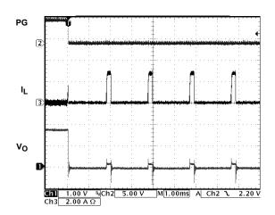
FIGURE 29. OVERCURRENT HICCUP MODE
