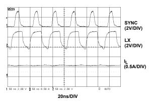
FIGURE 15. EXTERNAL SYNCHRONIZATION TO 12MHz
