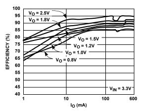
FIGURE 3. EFFICIENCY vs IO (PFM/FWM MODE)
