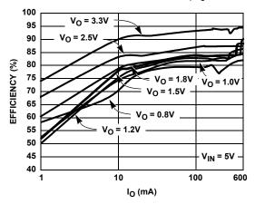
FIGURE 1. EFFICIENCY vs IO (PFM/PWM MODE)
