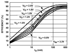
FIGURE 4. EFFICIENCY vs I<sub>O</sub> (PWM MODE)
