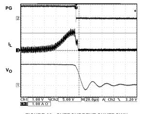
FIGURE 28. OVERCURRENT SHUTDOWN
