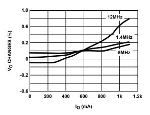
FIGURE 20. LOAD REGULATION (PWM MODE)
