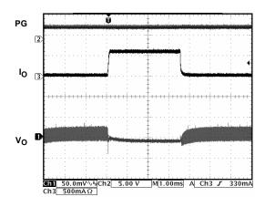
FIGURE 25. PFM-PWM LOAD TRANSIENT
