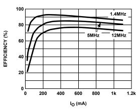
FIGURE 19. EFFICIENCY vs I<sub>O</sub> (PWM MODE)
