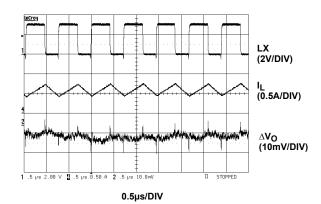
FIGURE 13. PWM STEADY-STATE OPERATION (I<sub>O</sub> = 600mA)
