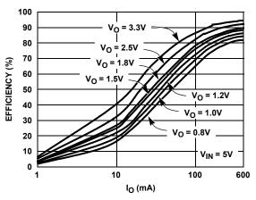
FIGURE 2. EFFICIENCY vs I<sub>O</sub> (PWM MODE)
