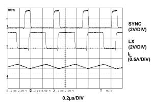
FIGURE 14. EXTERNAL SYNCHRONIZATION TO 2MHz
