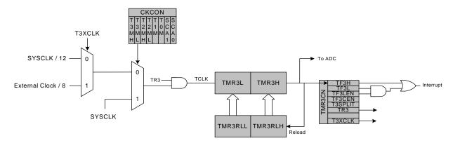
Figure 33.7. Timer 3 16-Bit Mode Block Diagram
