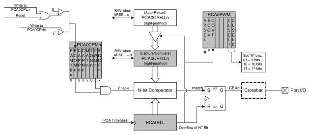
Figure 34.9. PCA 9, 10 and 11-Bit PWM Mode Diagram
