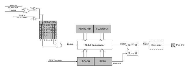
Figure 34.10. PCA 16-Bit PWM Mode
