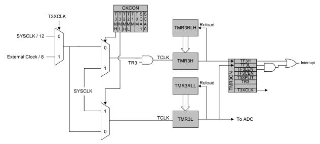
Figure 33.8. Timer 3 8-Bit Mode Block Diagram
