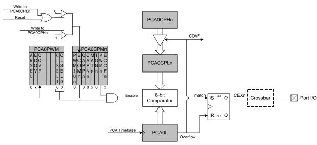
Figure 34.8. PCA 8-Bit PWM Mode Diagram
